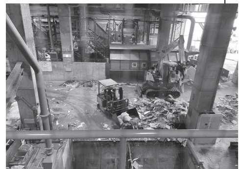
パッカー車から回収された大型ごみが出されています。布団などは裁断するため分けられています。
