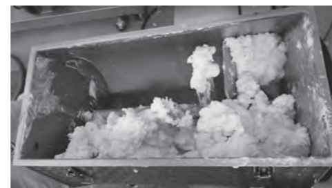
内部の羽が回転して 生クリームがバターへ
