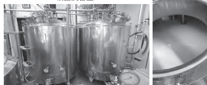
飲むヨーグルト専用殺菌発酵タンク
