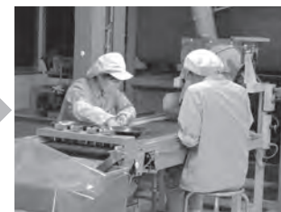
目視ライン(袋詰工程)異物が入っていないかを確認
